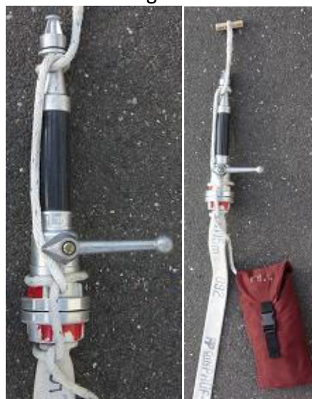
Bild 7 + 8: Mastwurf mit Halbschlag am CM-Strahlrohr mit Schlauch
